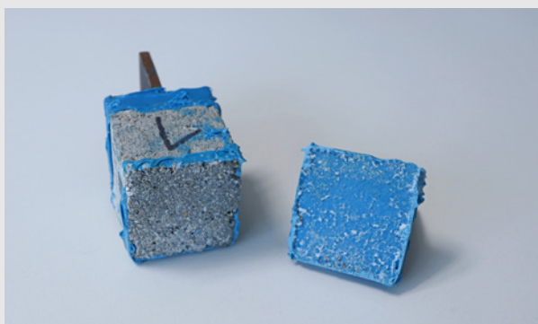
Bild 3: Probekörper 2 nach dem Versuch: Der Kleber hält
