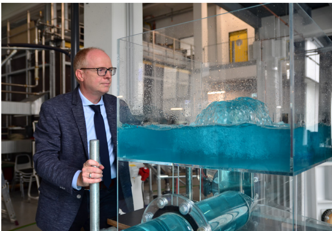
Prof. Dr. Helmut Grüning demonstriert an einem Versuchsstand den Rückstau aus dem Kanal in den Keller
